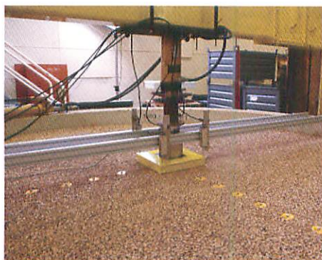
Test di capacità portante al BRE confermano che le geogriglie TriAx aumentano la distribuzione del carico
