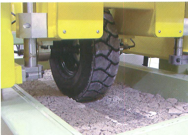
2007 - Il centro di Tecnologia Tensar - Una struttura di traffico interna consente di analizzare le geogriglie, i riempimenti e i substrati
