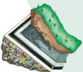
Discariche Geosintetici per la costruzione di discariche di rifiuti solidi e liquidi.
