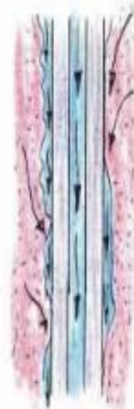
Schema di sifonamento longitudinale di una canalizzazione (pianta e sezione)
